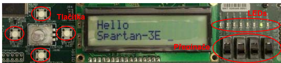
Obrázek 2 Tlačítka, přepínače a LED na vývojové desce S3ESK
