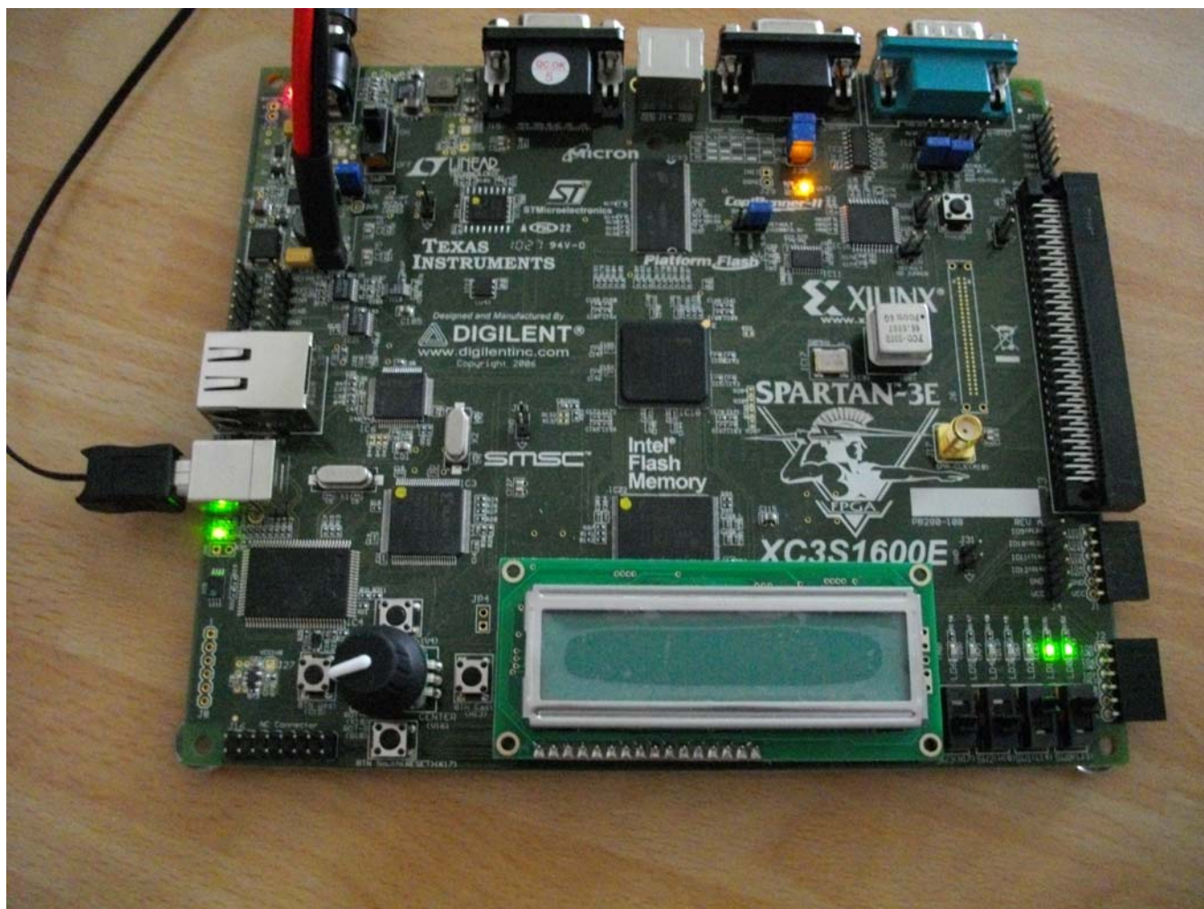
Obrázek 6: Funkční vzorek modulu řadiče elektronického potenciometru BASIC_IO_CORE na desce S3E1600
